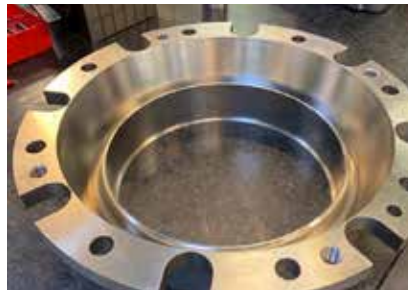
Flansch aus 1.4435, Löcher mit DRA gebohrt
