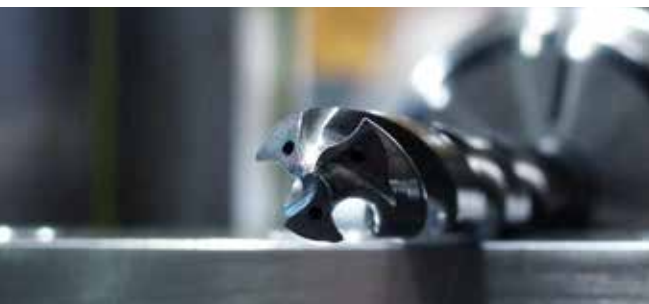
Nach über 300 m Bohrweg zeigt der dreischneidige Bohrer kaum Verschleisserscheinungen.
