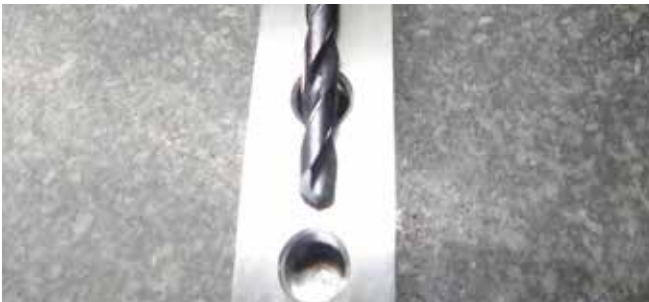
Mit dem Tieflochbohrer ADO-SUS (30 x D) wurde eine Losgrösse von 100 Stück mit nur einem Bohrer gebohrt und die Bearbeitungszeit pro Werkstück auf 4 bis 5 Minuten reduziert.
