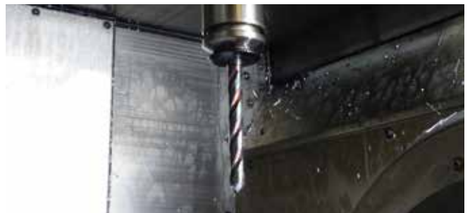
Die Schnittdaten, die Standzeit und Genauigkeit des ADO-TRS begeistern. Der Vorschub konnte gegenüber zweischneidigen Bohrern vervierfacht werden.
