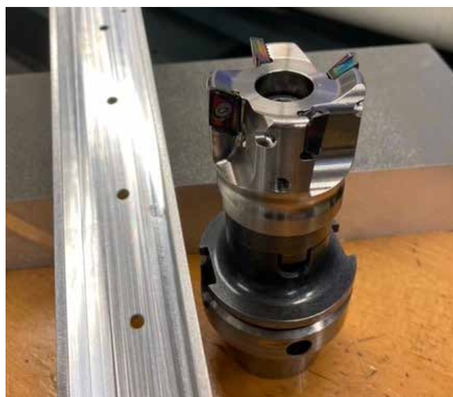
MEAS Planfräser (D=50mm) in Material EN AW-6082 und auf einer DMU 60eVo linear bearbeitetes Werkstück.
