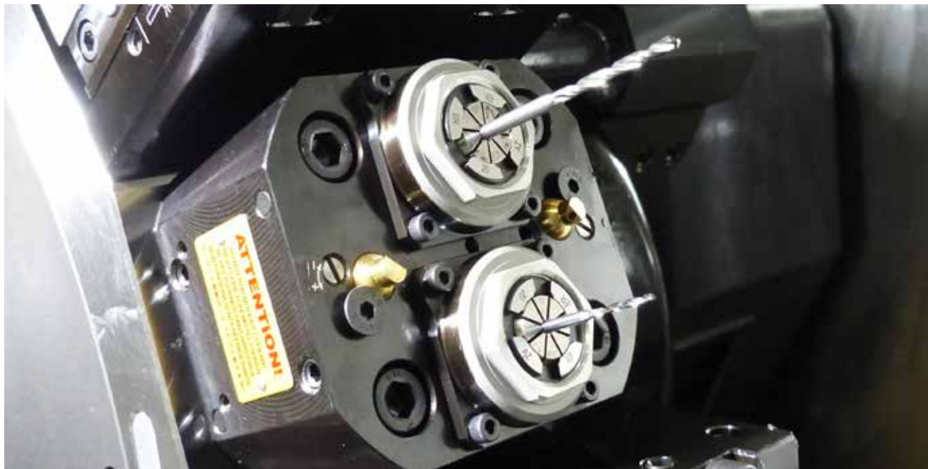
Mikro- und Tieflochbohrer der Serie ADO von OSG positionieren auch beim labilen Einspannen mit Spannzangen auf dem Revolver einer Langdrehmaschine hochgenau
