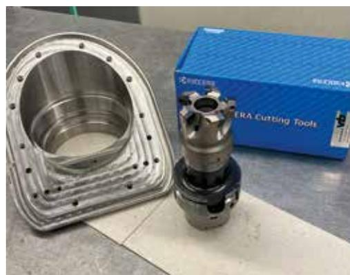
Der MFH-Harrier von Kyocera mit dem von Kyburz gefertigten Werkstück.
