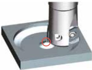
⊘ Unterschreitung des min. Bearbeitungsdurchmessers
