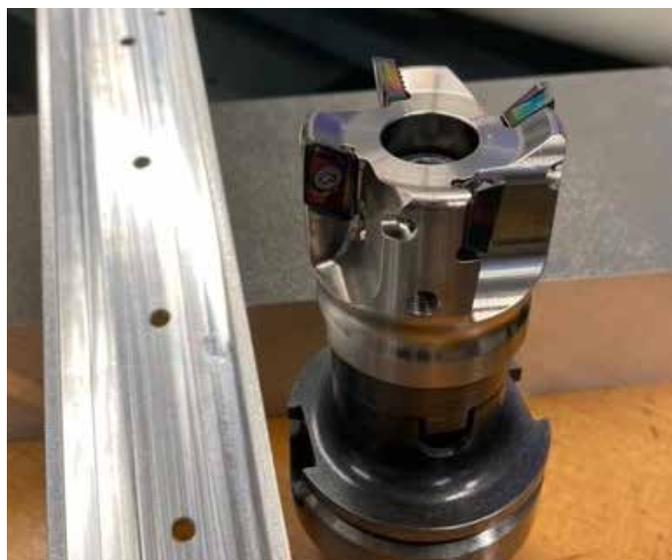
MEAS Planfräser (D=50mm) in Material EN AW-6082 und auf einer DMU 60eVo linear bearbeitetes Werkstück.
