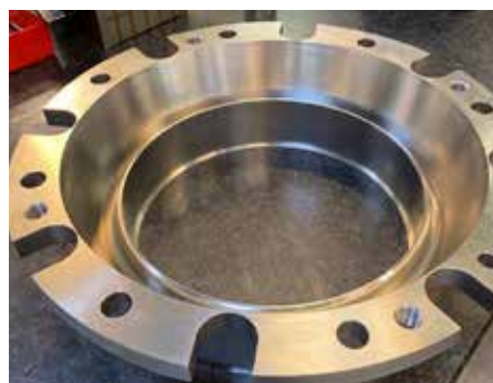
Flansch 1.4435, Löcher mit DRA gebohrt
