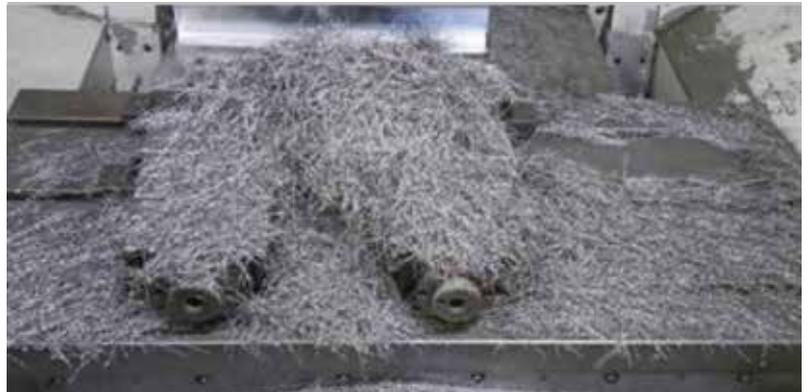
Grosse Späneanhäufungen können bei langen Bearbeitungen wie Umsäumen, Trochoidalfräsen oder Taschenfräsen problematisch sein.
