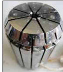
REGO-FIX rostfreie ER-Spannzange / Material: DIN 1.4122
