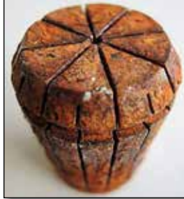
Standard ER-Spannzange / Material: herkömmlicher Federstahl
