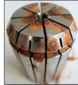
Rostfreie ER-Spannzange eines Mitbewerbers (DE) / Material: DIN 1.4034
