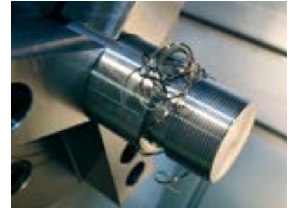
Beispiel für das Hängenbleiben von Spänen
